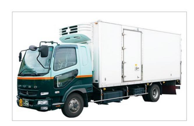
保有車両数:5台 最大積載量:2.45~2.85t 荷台サイズ:2.15m×5.70m×2.05m 対応温度範囲:-5~15℃
