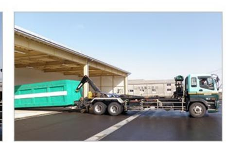
保有車両数:1台 / 最大積載量:11.8t / コンテナサイズ:2.30m×8.00m×1.80m
