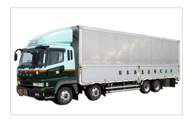
保有車両数:6台 最大積載量:13.4~13.6t 荷台サイズ:2.35m×9.60m×2.60m インターロック付 4軸低床仕様
